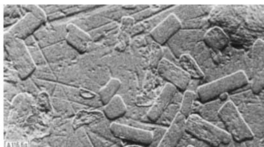
Abb. 6a. Phlogopitkristalle mit kleinem Verhältnis des Durchmessers zur Dicke.
