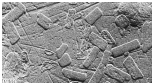
Abb. 4. Elektronenmikroskopisches Bild der Entmischung in einem Natriumborosilicatglas (Zusammensetzung siehe Abb. 3 (b)).
